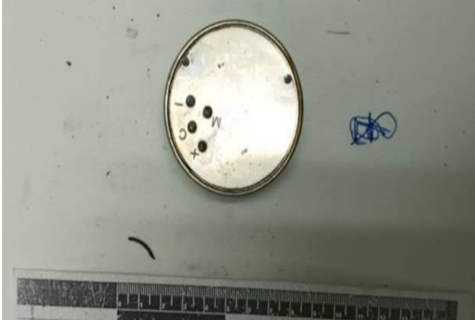
Рисунок 4 Контакти елемента живлення ЕАР-12081
