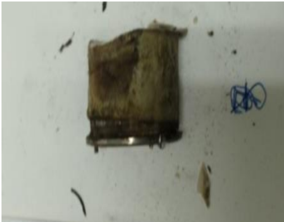
Рисунок 5 Внутрішня теплоізоляція елемента живлення ЕАР-12081.
